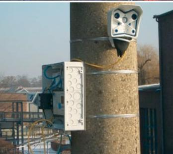
MOBOTIX Kamera mit der (während der Installation noch offenen) Mobile Connect Box für die UMTS-Übertragung.
