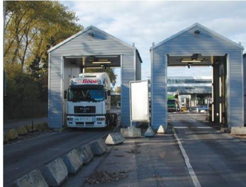
In diesen Scan-Portalen werden LKW und Trailer mit digitalen Kameras von allen Seiten erfasst.
