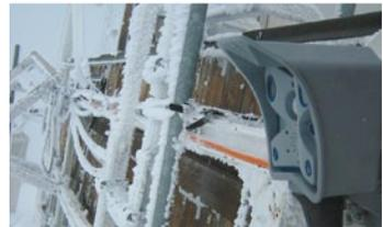
Kamera aufgebaut, die kontinuierlich das Auftreten der Bannerwolken zu dokumentieren. Tagsüber wird alle 5 Sekunden ein jpg-Bild abgespeichert. Nachts erzeugt der Rechner aus den Einzelbildern einen mpeg-Film, der dann im Institut ausgewertet wird.
