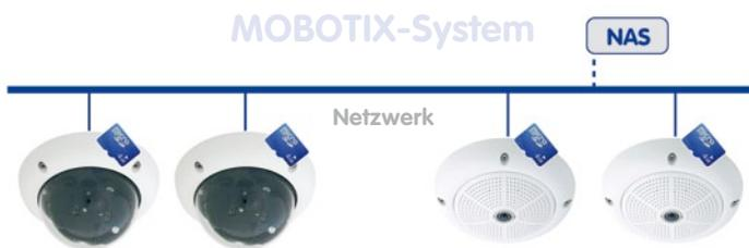
Software und Speicher in der MOBOTIX-Kamera integriert
